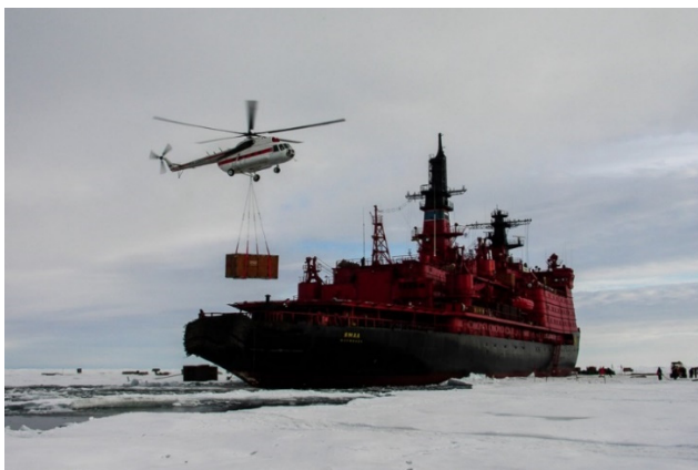
Рис. 2. Внепортовая выгрузка вертолетом груза
